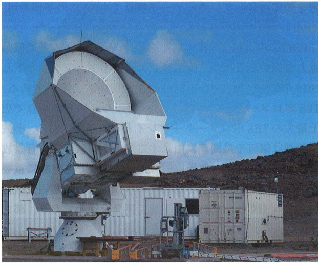
図8 チリ・アタカマに設置されたPOLARBEARプロジェクトの望遠鏡。設計者の名前をとってHuan Tran Telescope (HTT)と呼ばれている。主鏡の直径は3.5メートル。
