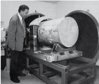
Der Aluminiumzylinder des in München wiederholten Gravitationswellen-Experiments Joseph Webers. Davor Heinz Billing, der den Versuchsaufbau in München leitete.
